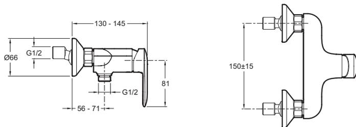
Спецификация продукта: Однорычажный настенный смеситель для душа. E99463. Коллекция: KUMIN. ВЕС: 1,3 кг. ТИП УСТАНОВКИ: Крепление к стене. ТИП: Однорычажный. РАСХОД ВОДЫ: 13 л/мин. ПОДКЛЮЧЕНИЕ: С настенными крепежами и кольцами. МЕХАНИЗМ: Керамический картридж с чувствительным ограничителем расхода воды. РАЗМЕТКА ОТВЕРСТИЙ: 150 ± 15 мм. СЛИВ: 0. ОДНОРЫЧАЖНЫЙ СМЕСИТЕЛЬ: 0. УСТАНОВКА: 2 отверстия. ГАРАНТИЯ НА ОТДЕЛКУ: 10 лет.
